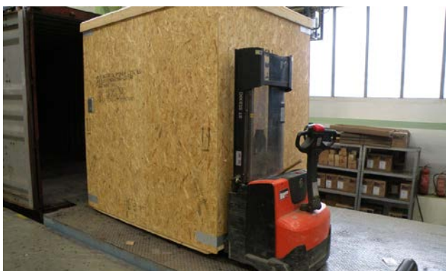
Рисунок 17. Подъем распределительного устройства, упакованного в деревянный ящик.
