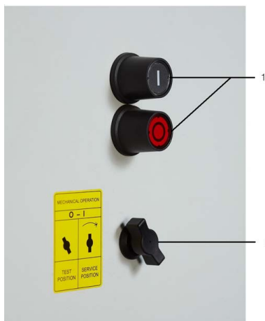
Рисунок 7. Кнопки включения/отключения выключателя при закрытой двери (по запросу). Если выкатной элемент находится в рабочем положении, операция выполняется при помощи поворотного рычага, который выдвигает штангу штока.
